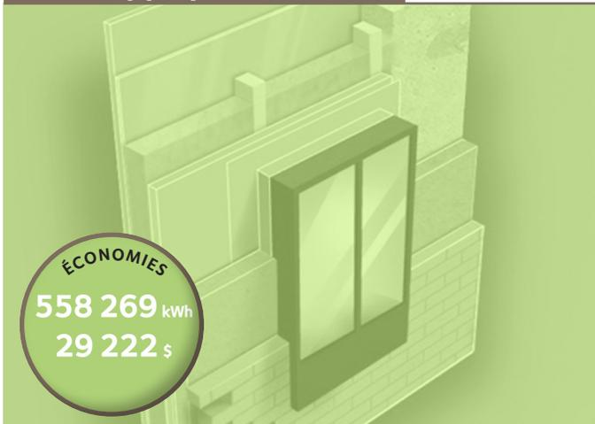
L'enveloppe d'un bâtiment permet de diminuer les pertes d'énergie et le protège de l'humidité et des rayons solaires. Sa performance sera déterminée par les caractéristiques des matériaux qui la composent et par leur agencement particulier.
