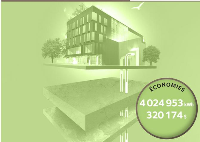
À l'origine, 80 % des besoins en chauffage et 100 % en climatisation étaient comblés par 28 puits de géothermie aménagés directement sous le bâtiment. Ces puits comblent à présent 100 % de ces besoins. Pour en savoir plus sur cette approche novatrice, consultez le site de la [MDD virtuelle](#), ou la borne interactive du [parcours d'interprétation de la MDD](#) qui lui est dédiée au rez-de-chaussée du bâtiment.
